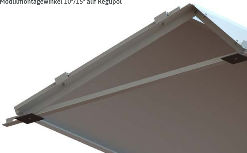
Windabweisblech mit Langlöchern zum Dehnungsausgleich ggf. auch gekantet zur Ballast-Aufnahme
