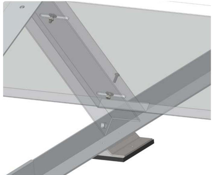
■ Die Windabweisbleche überlappend an den Einpress-Gewindemuttern der Stütz-Profile montieren. Die Schrauben dabei noch nicht fest anziehen.
