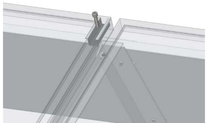
■ Module auflegen und mit den Mittel- bzw. Endklemmen in die Einpress-Gewindemuttern schrauben. Anschließend die Windabweiser festziehen.
