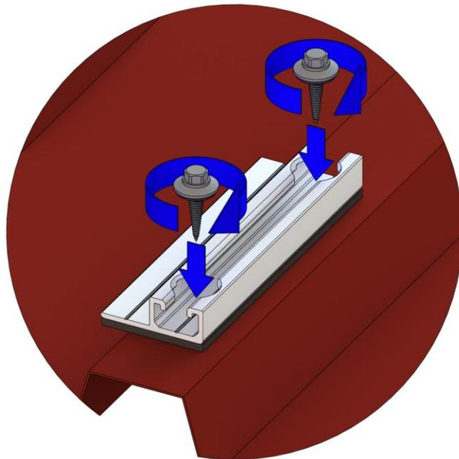
5. Sofern Sie die Kurzschienen ohne vorkonfektioniertes EPDM-Dichtband bestellt haben, so kleben Sie EPDM-Streifen auf die Sicken, auf denen das Profil aufgeschraubt wird, um eine optimale Abdichtung zu gewährleisten.
