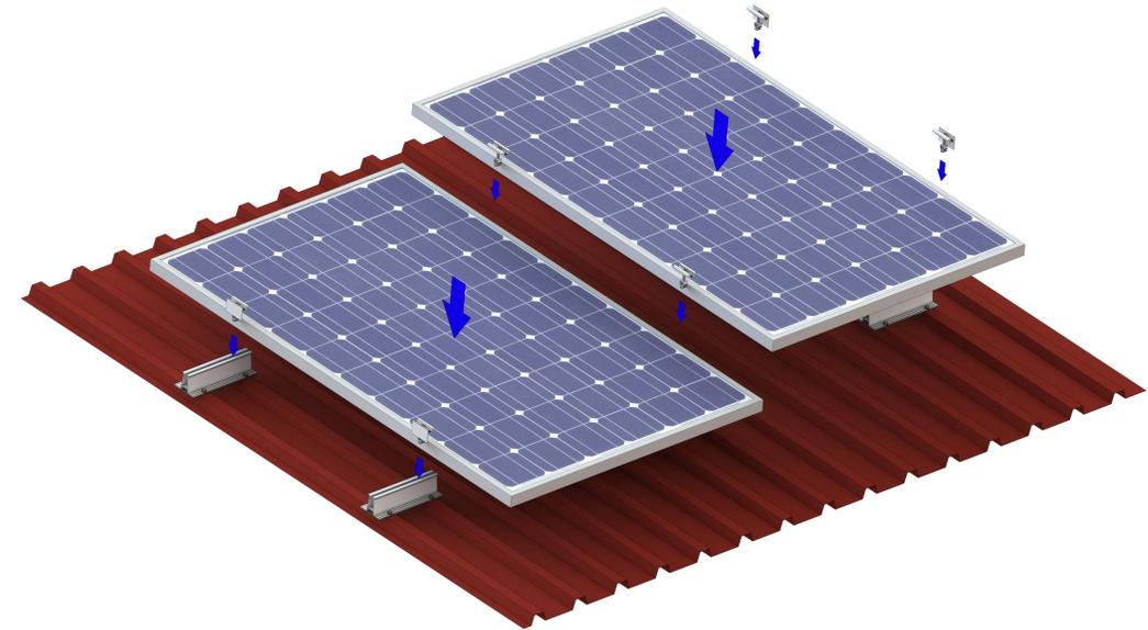
8. Um nicht zu viel Platz zu verlieren kann man die Trapezschienen bei der Hochkant-Montage mit Brücken an einer Dehnungsfuge versetzt montieren. Man setzt dann zwei Schienen direkt übereinander, sodass eine Reihe endet und eine neue Reihe beginnt (10 cm darüber oder darunter).
