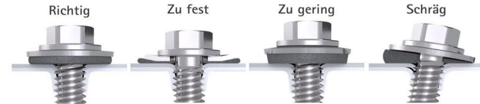
Damit die Schraube nicht durchdreht und die Dichtscheibe nicht beschädigt wird, empfehlen wir ein Anzugsmoment von **3 - max. 5 Nm**.
