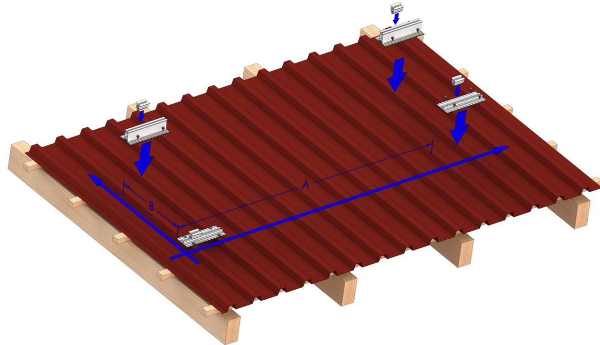
A = Länge des Moduls an der kurzen Rahmenseite
