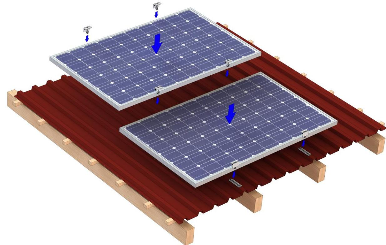
8. Die Module sollten in der Richtung Ortgang zu Ortgang nicht auf Stoß montiert werden (Modulrahmen direkt an Modulrahmen), sondern mindestens 1,5 cm Abstand gelassen werden
