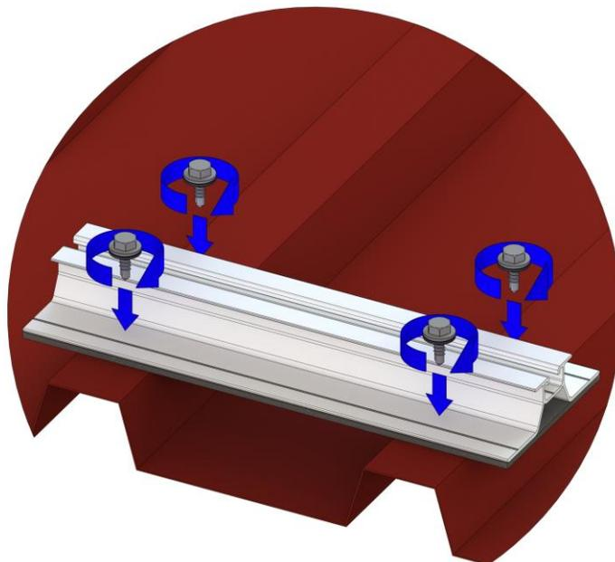
5. Sofern Sie die Kurzschienen ohne vorkonfektioniertes EPDM-Dichtband bestellt haben, so kleben Sie EPDM-Streifen auf die Sicken, auf denen das Profil aufgeschraubt wird, um eine optimale Abdichtung zu gewährleisten.
