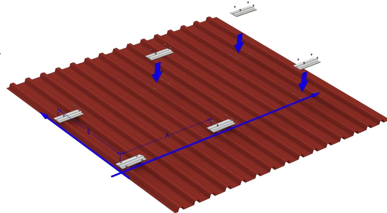
**A** = Länge des Moduls an der kurzen Rahmenseite (Die Klemmung der Module muss zwischen zwei Sicken liegen)
