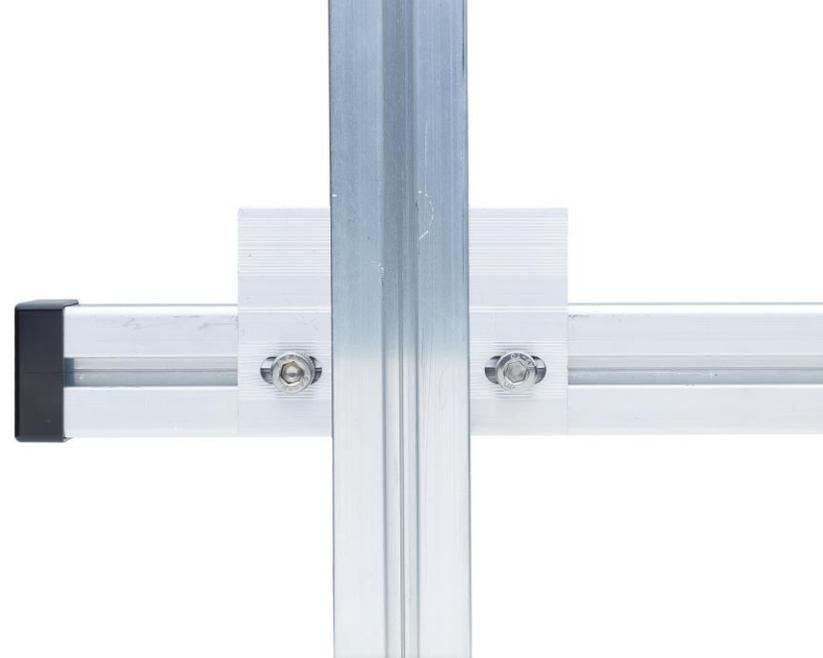
Befestigung mit PROFINESS **Connect X Kreuzverbinderplatte** mit Performance Schienen (40x40 mm, 20x40 mm und 80x40 mm) mit unterer Anbindung (M10) sowie Strong Montageschienen. Platte mit zwei Langlöchern für M8er-Verschraubung und einem Langloch für M10er-Verschraubung. Es werden zusätzlich Innensechskantschraube (M8x16) und Nutensteine (M8) benötigt.
