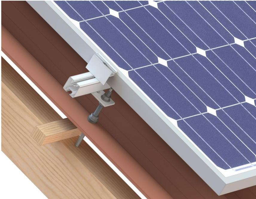
Achten Sie darauf, dass die Montageschienen gleichmäßig, parallel zum First ausgerichtet sind und die Montageschienen im Klemmbereich der Module ausgerichtet sind.
