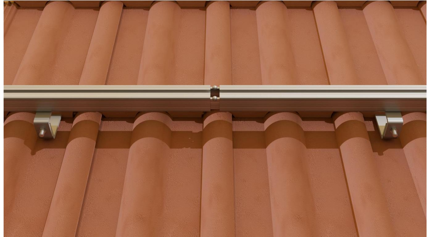
*Die Grafik zeigt exemplarisch die Einschubverbinder inkl. Nasen, welche für einen stabilen Sitz im Profilkanal eingeschlagen werden. Beide Montageschienen werden mit Druck bündig auf den Verbindern zusammengeschoben, sodass ein Formschluss entsteht.*
