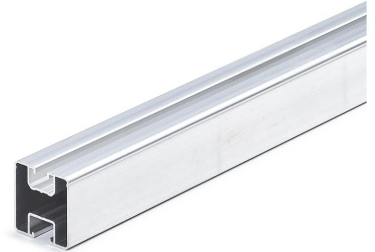
Für die untere Anbindung am Dachhaken haben die PROFINESS-Systemträger unten einen Schienenkanal für eine M10 Verschraubung. Diese Befestigung kann entweder mit PROFINESS-Hammerkopfschraube erfolgen, die an jeder Stelle des Profils eingedreht werden kann, oder mit einer Sechskantschraube M10 (DIN 933), die seitlich in den Schienenkanal eingeschoben wird.
