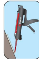
Mörtelvorlauf verwerfen (bis der Mörtel eine einheitliche Farbe aufweist – ca. 10 cm)
