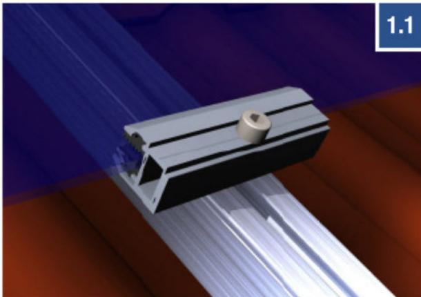
**BILD 2:** Den Nutenstein in die obere Schiene schwenken und einklicken. Die Endklemme mit einer Schraube DIN 912 A2/A4 M8\*35mm in den Nutenstein drehen und festziehen.
