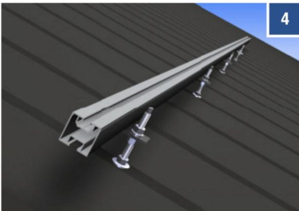
Montieren Sie die Montageschienen für jede Modulreihe mit Hilfe von verschiedenen Schrauben und Muttern: (Bei **BILD 2** und **BILD 3** können natürlich auch selbstsichernde Muttern DIN 985 mit Unterlegscheiben verwendet werden; Anzugsmoment max. 25 Nm.) Bitte im Vorfeld nötige Schienenverbinder prüfen (siehe Seite 10.)
