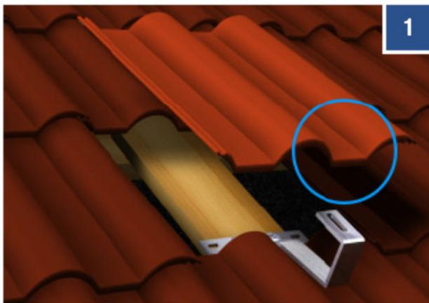
An den jeweiligen Positionen die Dachsteine entfernen oder ggf. auch nur hochschieben. Den jeweiligen Dachhaken positionieren, er darf dabei nicht gegen den Dachstein gedrückt werden.
