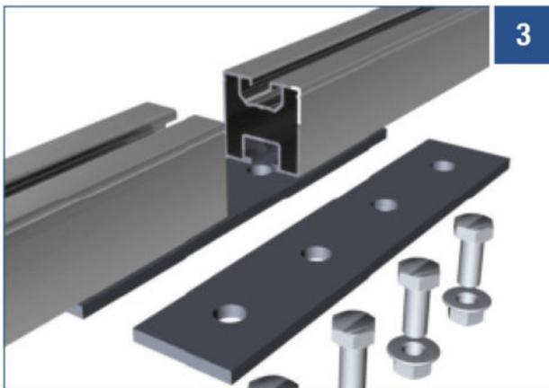
**BILD 3:** Den Verbinder (4-Loch) mit vier 6-Kant-Schrauben versehen und die ersten zwei Schraubenköpfe in den unteren Kanal der ersten Montagesschiene schieben. Danach die letzten zwei Schrauben in die andere Schiene schieben. Dann alle vier Schrauben mit jeweils 4 Muttern befestigen. (Anzugsmoment max. 25Nm)
