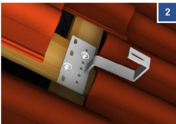
Falls notwendig, den Dachstein über dem Dachhaken an der Stelle der Durchführung des Dachhakens mit Hilfe eines Trennschleifers aussparen. Der Dachhaken soll den darüber liegenden Dachstein nicht aufrichten. Bei Falzziegeln empfiehlt es sich den unteren Ziegel ebenfalls auszusparen.
