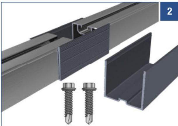
**BILD 2:** Den Verbinder (PROFINESS 12) über die erste Montagesschiene stecken und die vorhandene Rille einklicken. Danach die zweite Montagesschiene einklicken und beide zusammendrücken. Danach diese Verbindung mit zwei Bohrschrauben über Kreuz verschrauben. (Anzugsmoment 8-10 Nm)
