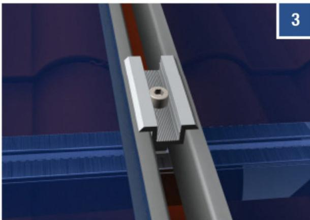
**BILD 2.1** : Den Nutenstein in die obere Schiene schwenken und einklicken. Die Endklemme mit dazugehöriger Schraube (je nach Modulhöhe) in den Nutenstein drehen. Alternativ Klickbausatz in den oberen Kanal der Schiene einklicken und festziehen.
