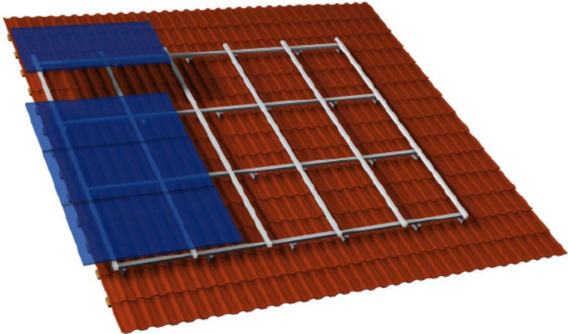
**BILD 1:** Den Nutenstein in die obere Schiene schwenken und einklicken. Die Endklemme mit einer Schraube DIN 912 A2/A4 M8\*35mm in den Nutenstein drehen und festziehen. Anzugsmoment nach Vorgabe des Modulherstellers.
