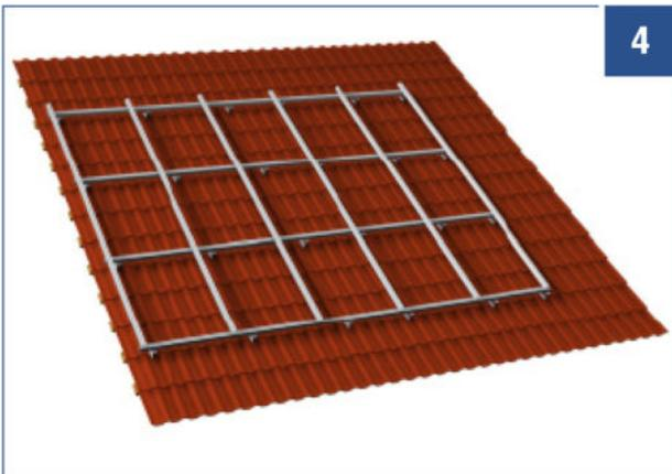
Bei der Verlegung von nicht gerahmten PV-Modulen ist eine Montage im Kreuzverband evt. vorgeschrieben. Dabei handelt es sich um eine besonders stabile Konstruktion. Bitte Montagevorgaben der Modulhersteller berücksichtigen.
