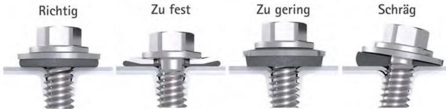
Wir empfehlen bei einer Verschraubung auf Trapezblech eine nicht zu hohe Verarbeitungsdrehzahl von ca. 1.200 U/min.
