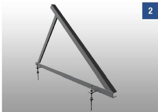
Fig. 2: 9785-... Questo supporto viene costruito su disegno del cliente, che può decidere le misure per l'angolazione. Il supporto viene consegnato premontato e devono essere semplicemente montate le viti a doppia filettatura e gli adattatori. Questo supporto viene prodotto con profili a L in alluminio (40*40*3,4 o 5)
